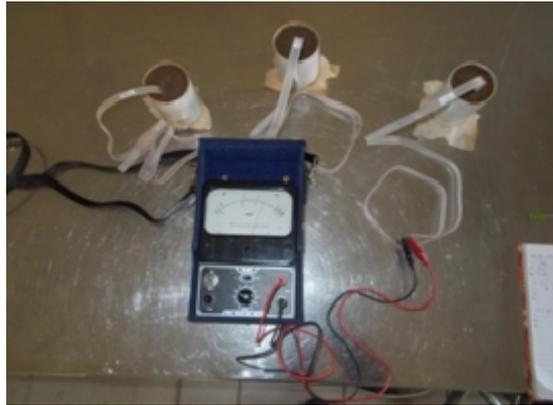
Gambar 1. Proses kalibrasi kadar air tanah (%) dan tahanan
